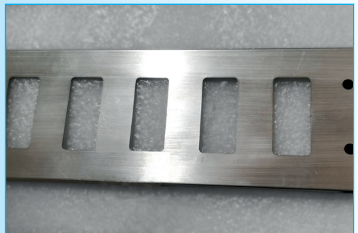
Kalibrierschablone zur Realisierung der hochgenauen Bandbreiten-/ Streifenbreitenmessung
