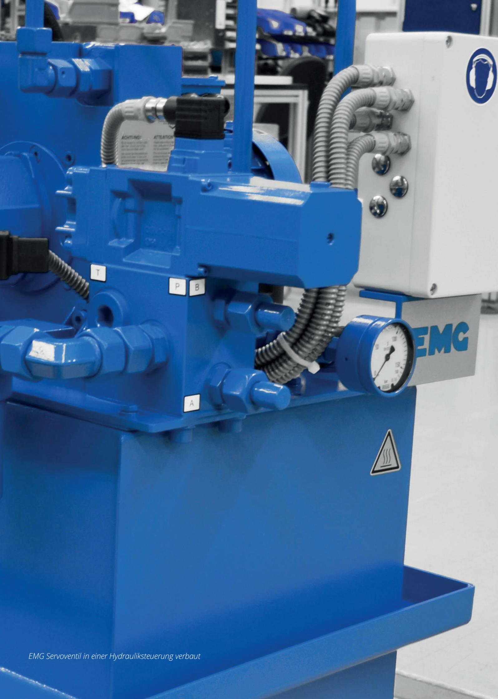
*EMG Servoventil in einer Hydrauliksteuerung verbaut*
