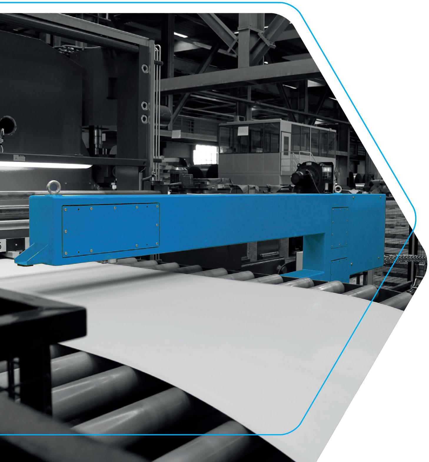
EMG iTiM – Präzisionsmesstechnik zur Dickenmessung
