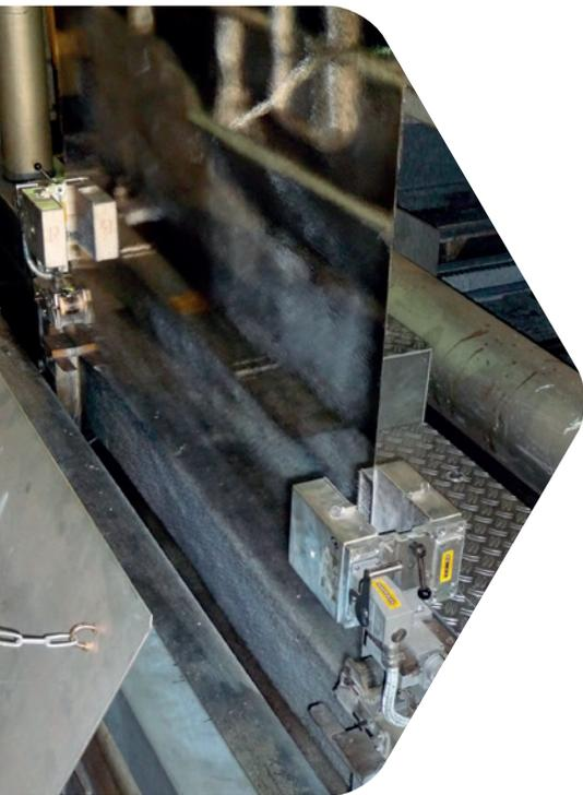
Damit können Beeinträchtigungen der Beschichtung an den Bandkanten („Aufwachsungen“) verhindert und außerdem der Geräuschpegel der Luftströmung deutlich reduziert werden.
