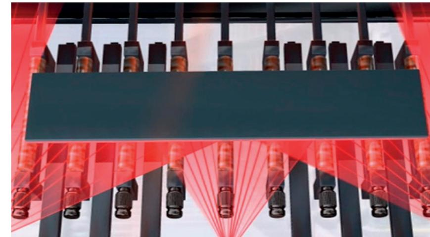
Funktionsprinzip der Brammenpositionsmessung am Rollgang
